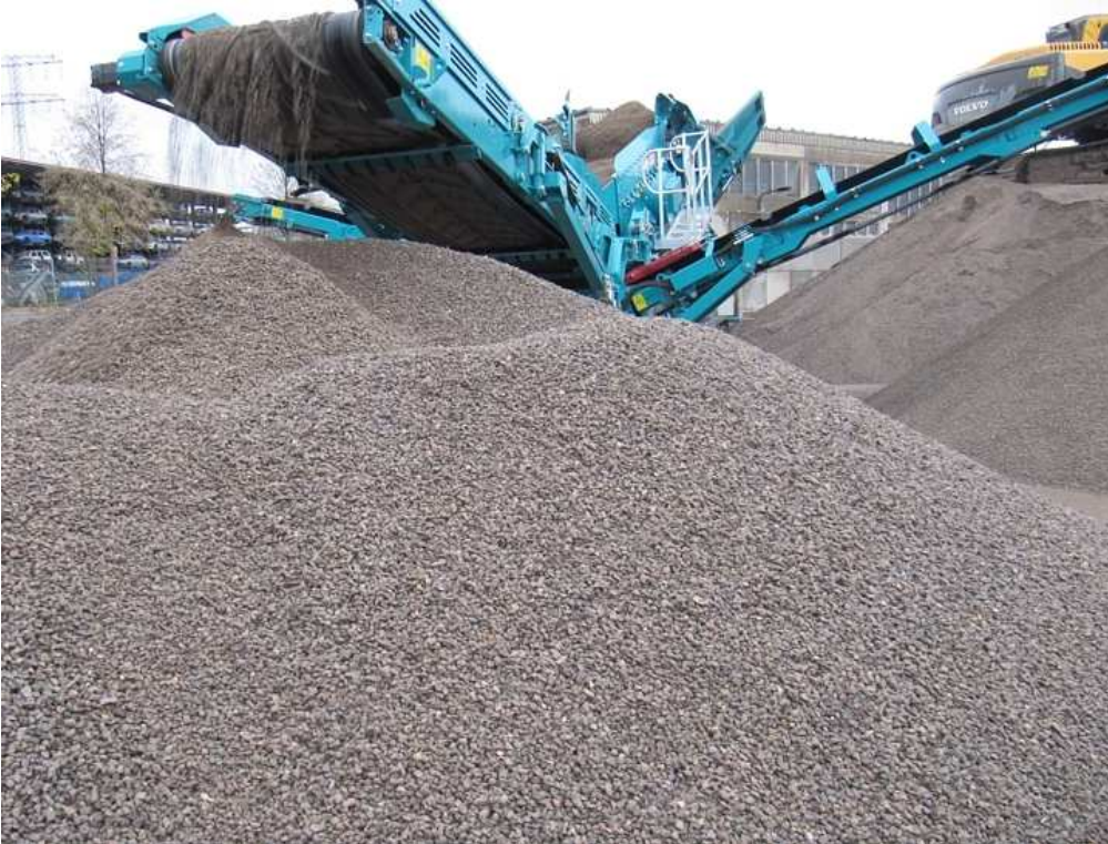
Aufbereitung von Recyclingbeton, Quelle: SenUMVK
